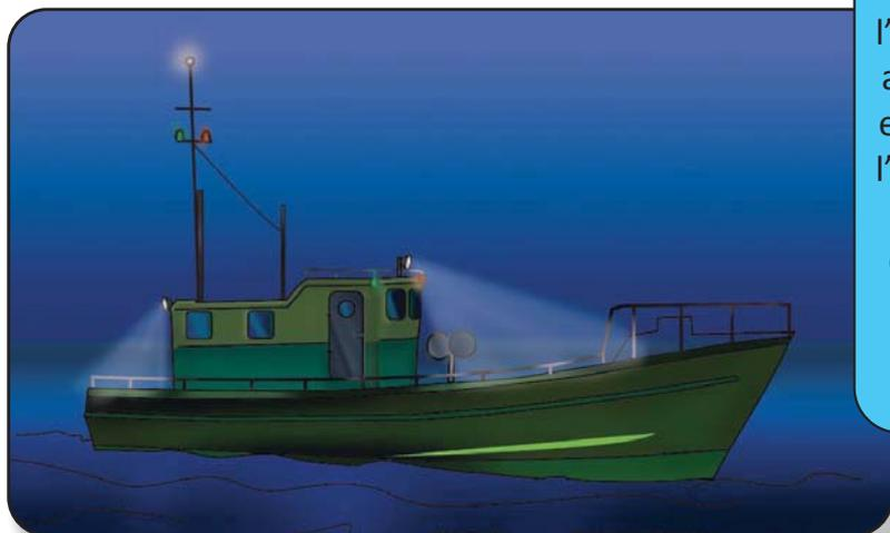
Pendant la pêche, veillez à ce que l'éclairage du pont reste allumé, sauf si l'activité exige l'obscurité. Placez l'éclairage de façon à ne pas éblouir l'équipage et ne pas gêner le bon fonctionnement des feux de navigation réglementaires.
