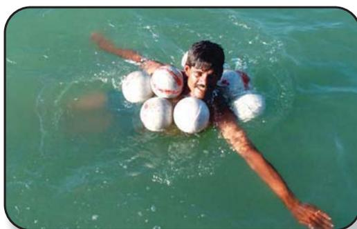
Floteur de sauvetage FRP pour les grands navires en alternative au radeau de sauvetage gonflable\*
