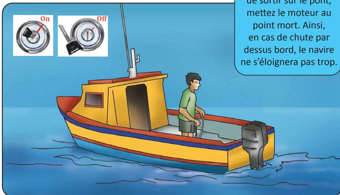
Si vous êtes seul à bord et vous avez besoin de sortir sur le pont, mettez le moteur au point mort. Ainsi, en cas de chute par dessus bord, le navire ne s'éloignera pas trop.
